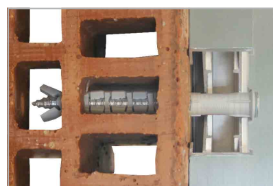
WALL PLUS3 Drill hole Ø 8 mm - fixing of window/door frame with FM-X5 WALL PLUS3 Trou de perçage Ø 8 mm - Fixation d'huissierie avec FM-X5
